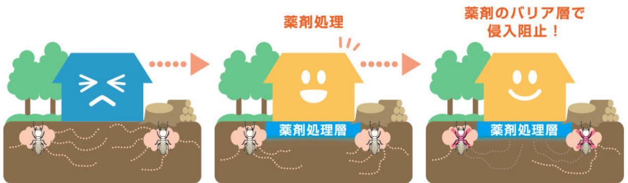
シロアリは、樹木の根回りや廃材等の接地部分に巣をつくり、地中で餌を探し回ります。また、障害物にぶつかると上に向かって蟻道を作る習性があるため、建物へも侵入してきてしまいます。その侵入を断ち、被害を予防するには、床下地面（基礎の内側や束石の周囲、その他シロアリの通り道となる土壌）に薬剤を処理してバリア層をつくる方法が最も一般的かつ効果的です。
